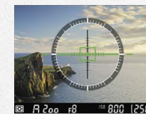
Virtueller Horizont zum Erkennen von Drehung und Neigung
