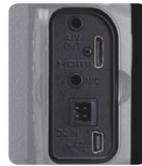
Die D300S ist mit einem HDMI-Anschluss (High-Definition Multimedia Interface) ausgestattet und lässt sich zur atemberaubenden Präsentation von Bildern und D-Filmsequenzen direkt an ein HDTV-Gerät anschließen. Ein Ministecker Typ C wird benötigt.
