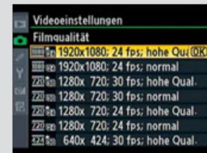
**Auswählbar:** Dreht man mit der D7000 Videos, kann man unter mehreren Auflösungen, Bildwiederholraten und Qualitätsstufen wählen.
