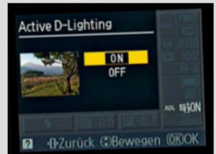
**D-Lighting:** Die D3100 ist mit einer Dynamikoptimierung ausgestattet, die bei starken Kontrasten mehr Zeichnung ins Bild bringt.
