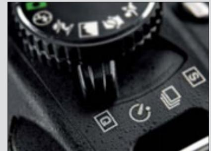
**Leise:** Steht der Schalter in der »Q«-Position, deaktiviert die D3100 sämtliche Kameratöne, sodass man fast geräuschlos auslösen kann.
